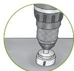
1. Réaliser le trou d'encastrement : Ø 60mm
